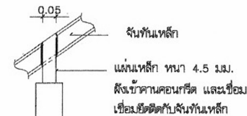
การติดตั้งจันทันเหล็กที่พาดผ่านคานหรือเสาคอนกรีต
