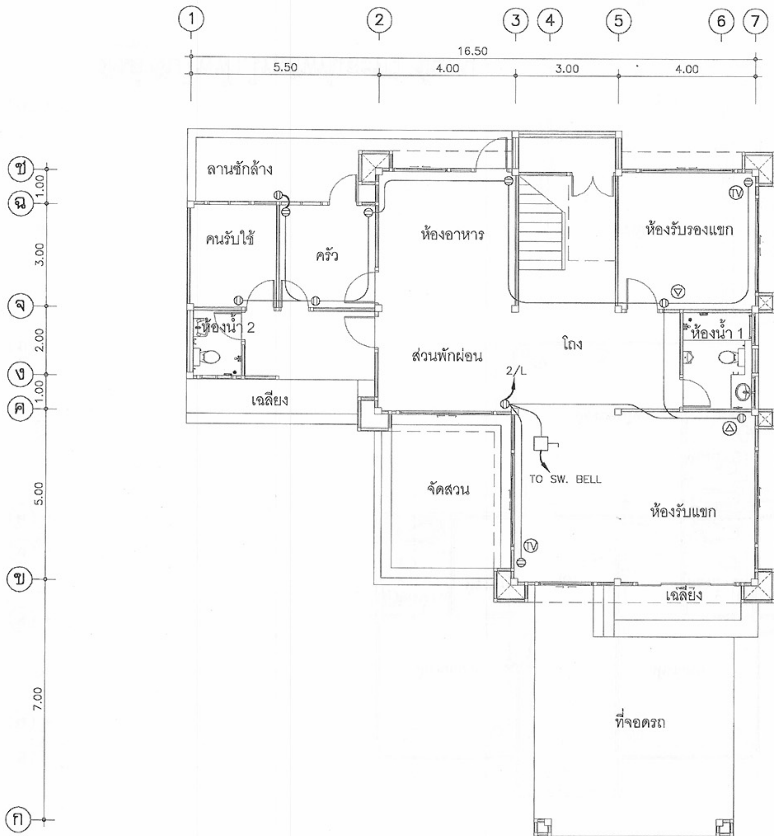
ผังเดินรับไฟฟ้า, โทรศัพท์และทีวี ชั้นล่าง มาตราส่วน 1:100
